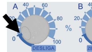
3. Ligue o equipamento, girando o potenciômetro de ajuste do canal 'A' (esquerda) até ouvir um 'click', de modo com que o chanfro de posição do potenciômetro deixe a posição DESLIGAR e posicione-se sobre o 0 (zero) da escala.
