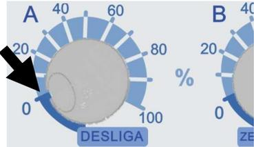
2. Ligue o equipamento, girando o potenciômetro da esquerda o suficiente apenas para ouvir o click da chave;
