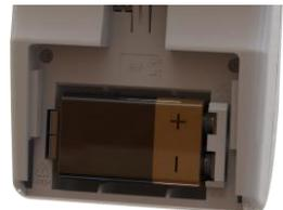
Antes de utilizar uma bateria, inspecione-a para verificar a presença de vazamentos, descoloração, deformação ou qualquer outra anormalidade. Não utilize baterias com indícios de violação em seu corpo, isto pode favorecer o surgimento de vazamentos.
