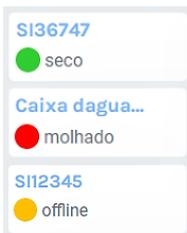
Os sensores de líquido instalados na planta são visualizados como círculos coloridos onde cada cor representa um “status” diferente.
