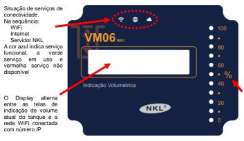
A barra lateral indica o volume atual do tanque em porcentagem (%), mostrando também o status do tanque, alterando a cor da barra en verde para nível normal, amarelo para mínimo e vermelho para crítico
