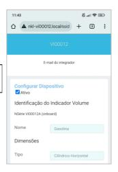
Informe as grandezas dimensionais do tanque conforme citadas abaixo. É possível utilizar a própria ficha de dados fornecida pelo fabricante do tanque, considerando que esta situação pode distorcer valores em função das tolerâncias de fabricação.
