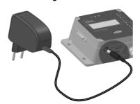
Para iniciar o funcionamento do VM06 WiFi, inicialmente conecte a fonte de alimentação original do equipamento em seu respectivo ponto de conexão no gabinete...
